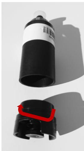
INLET-Kappe am i3 TrackPor M Monitor Boden LANGSAM abdrehen oder durch leichte Kippbewegen abnehmen
